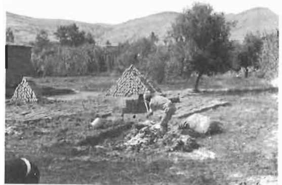
FIGURE 170 : STOCKAGE DE BRIQUES AVEC DRAINAGE (ALLEMAGNE DE L'EST)
