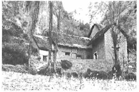
FIGURE 161 : LE TOIT EST EN CHAUME D'ICHU SERVANT ÉGALEMENT À FABRIQUER L'ADOBÉ (PÉROU)
