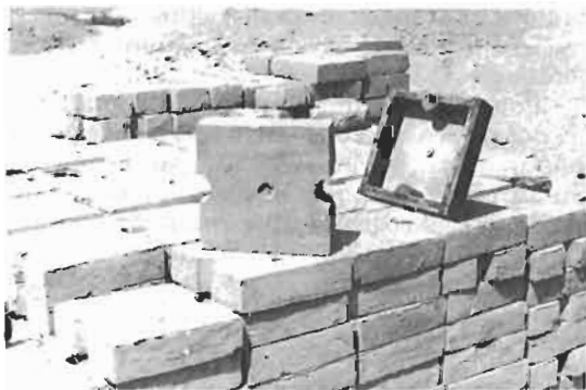
FIGURE 211 : MOULE ET BRIQUE (MAISON EXPERIMENTALE DE LIMA)
